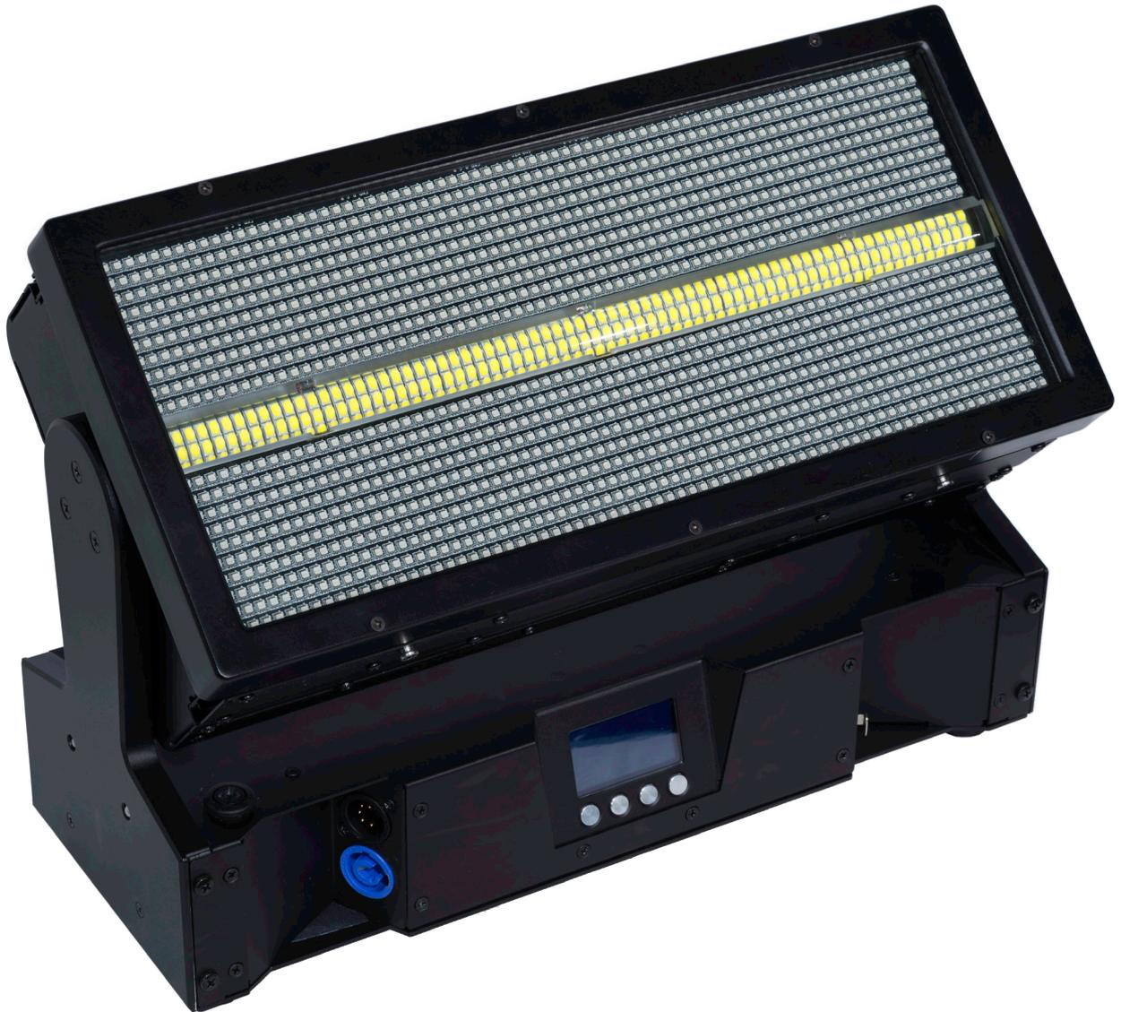
Das JDC-1 ist ein äußerst vielseitig einsetzbares LED Strobe: Das vollflächige LED Panel mit 1440 RGB-LEDs kann als Strobe, Dauerbeleuchtung oder, durch die einzelne Ansteuerung der 12 Segmente, als animierte Farbfläche genutzt werden. Zusätzlich bietet eine mittig angeordnete Linie bestehend aus 216 ultrahellen weißen LEDs einen knackigen Strobe-Effekt mit bis zu 170.000 Lumen\*.
